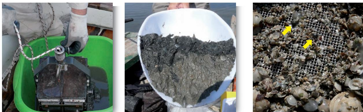
Fig. 3.2 - Diverse fasi del campionamento del fondale di una zona umida (foto F. Borghesi); il sedimento viene prima raccolto con una benna, successivamente estratto e setacciato. Nell'immagine di destra le frecce indicano due pallini di piombo.
