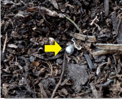
Fig. 3.1 - Pallino di piombo nel terreno (foto A. Andreotti). Si può notare come i processi di alterazione superficiale in corrispondenza della freccia abbiano portato alla formazione di una crosta biancastra di forma irregolare.
